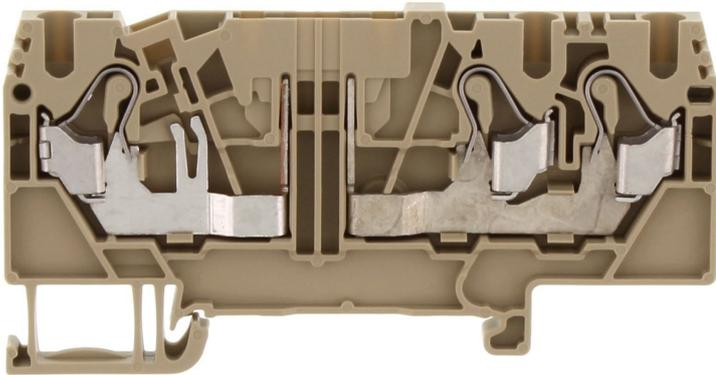
Grundklemme, Push-in-Anschluss, Montageart: TS 35/7,5, Bemessungsquerschnitt: 2,5 mm<sup>2</sup>, Breite: 5,1 mm, Farbe: Beige
