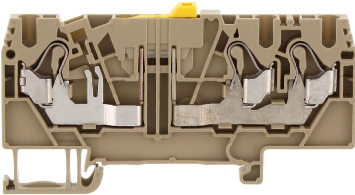
Messertrennklemme, Push-in-Anschluss, Montageart: TS 35/7,5, Bemessungsquerschnitt: 2,5 mm<sup>2</sup>, Breite: 5,1 mm, Farbe: Beige
