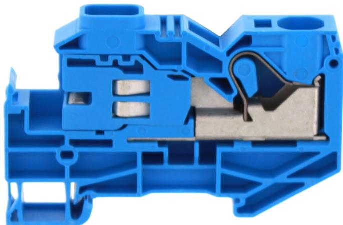
Neutralleiter-Trennklemme, Push-in-Anschluss, Montageart: TS 35/7,5, Bemessungsquerschnitt: 16 mm<sup>2</sup>, Breite: 12,1 mm, Farbe: Blau
