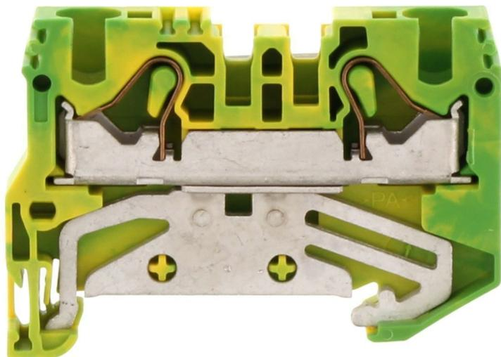
Schutzleiter-Installationsklemme, Push-in-Anschluss, Montageart: TS 35/7,5, Bemessungsquerschnitt: 10 mm<sup>2</sup>, Breite: 8,1 mm, Farbe: Grün-gelb
