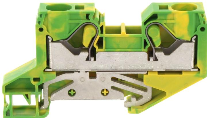
Schutzleiter-Installationsklemme, Push-in-Anschluss, Montageart: TS 35/7,5, Farbe: Grün-gelb
