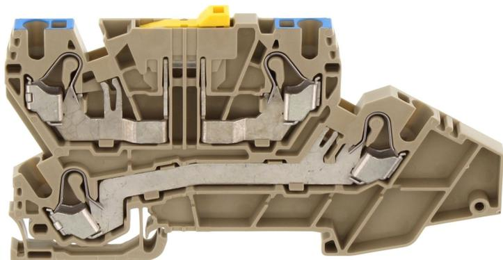
Dreileiter-Installationsklemme, Push-in-Anschluss, Montageart: TS 35/7,5, Bemessungsquerschnitt: 4 mm<sup>2</sup>, Breite: 5,1 mm, Farbe: Beige
