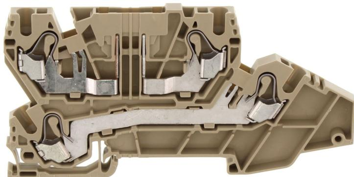
Dreileiter-Installationsklemme, Push-in-Anschluss, Montageart: TS 35/7,5, Bemessungsquerschnitt: 4 mm<sup>2</sup>, Breite: 5,1 mm, Farbe: Beige
