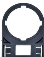
Schildhalter, einsetzbar für alle Taster und Schalter mit 22 mm Durchmesser, schwarz, unbeschriftet, Montageart: schrauben, nieten, Durchmesser 22 mm, Schriftfeldgröße: 27 x 8 mm, Farbe: Schwarz
