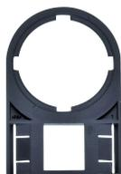
Schildhalter, einsetzbar für alle Taster und Schalter mit 22 mm Durchmesser, schwarz, unbeschriftet, Montageart: schrauben, nieten, Durchmesser 22 mm, Schriftfeldgröße: 27 x 8 mm, Farbe: Schwarz
