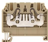
Durchgangsklemme, Push-in-Anschluss, Montageart: TS 35/7,5, Bemessungsquerschnitt: 1,5 mm<sup>2</sup>, Breite: 4,1 mm, Farbe: Beige
