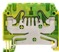
Schutzleiterklemme, Push-in-Anschluss, Montageart: TS 35/7,5, Bemessungsquerschnitt: 2,5 mm<sup>2</sup>, Breite: 5,1 mm, Farbe: Grün-gelb
