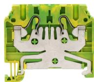
Schutzleiterklemme, Push-in-Anschluss, Montageart: TS 35/7,5, Bemessungsquerschnitt: 1,5 mm<sup>2</sup>, Breite: 4,1 mm, Farbe: Grün-gelb
