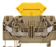
Trennklemme, Push-in-Anschluss, Montageart: TS 35/7,5, Bemessungsquerschnitt: 2,5 mm<sup>2</sup>, Breite: 5,1 mm, Farbe: Beige
