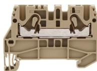
Durchgangs-Installationsklemme, Push-in-Anschluss, Montageart: TS 35/7,5, Bemessungsquerschnitt: 4 mm<sup>2</sup>, Breite: 5,1 mm, Farbe: Beige
