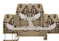
Doppelstockklemme, Push-in-Anschluss, Montageart: TS 35/7,5, Bemessungsquerschnitt: 2,5 mm<sup>2</sup>, Breite: 5,1 mm, Farbe: Beige
