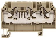
Durchgangsklemme, Push-in-Anschluss, Montageart: TS 35/7,5, Bemessungsquerschnitt: 4 mm<sup>2</sup>, Breite: 6,1 mm, Farbe: Beige
