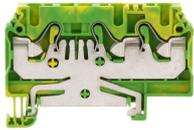
Schutzleiterklemme, Push-in-Anschluss, Montageart: TS 35/7,5, Bemessungsquerschnitt: 4 mm<sup>2</sup>, Breite: 6,1 mm, Farbe: Grün-gelb
