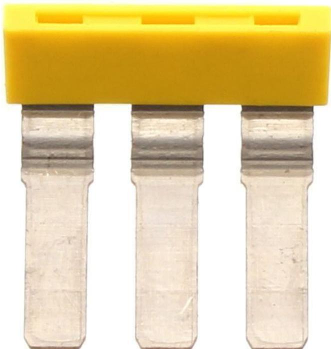
Aussenquerverbinder isoliert, Polzahl: 3, Montageart: Stecken, Breite: 24,2 mm, Bemessungsstrom: 57 A, Farbe: Gelb
