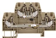
Doppelstockklemme mit elektronischen Bauteilen, Push-in-Anschluss, Montageart: TS 35/7,5, Bemessungsquerschnitt: 2,5 mm<sup>2</sup>, Breite: 5,1 mm, Farbe: Beige
