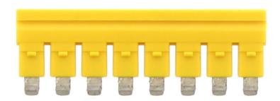
Querverbinder isoliert, Polzahl: 8, Montageart: Stecken, Breite: 40,7 mm, Farbe: Gelb
