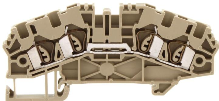
Durchgangsklemme, Zugfederanschluss, Montageart: TS 35/7,5, Bemessungsquerschnitt: 2,5 mm<sup>2</sup>, Breite: 5,1 mm, Farbe: Beige
