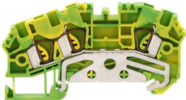
Schutzleiterklemme, Zugfederanschluss, Montageart: TS 35/7,5, Bemessungsquerschnitt: 2,5 mm<sup>2</sup>, Breite: 5,1 mm, Farbe: Grün-gelb
