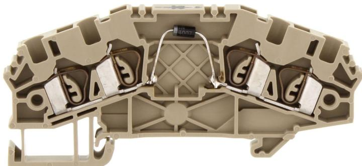
Doppelstockklemme mit elektronischen Bauteilen, Zugfederanschluss, Montageart: TS 35/7,5, Bemessungsquerschnitt: 2,5 mm<sup>2</sup>, Breite: 5,1 mm, Farbe: Beige
