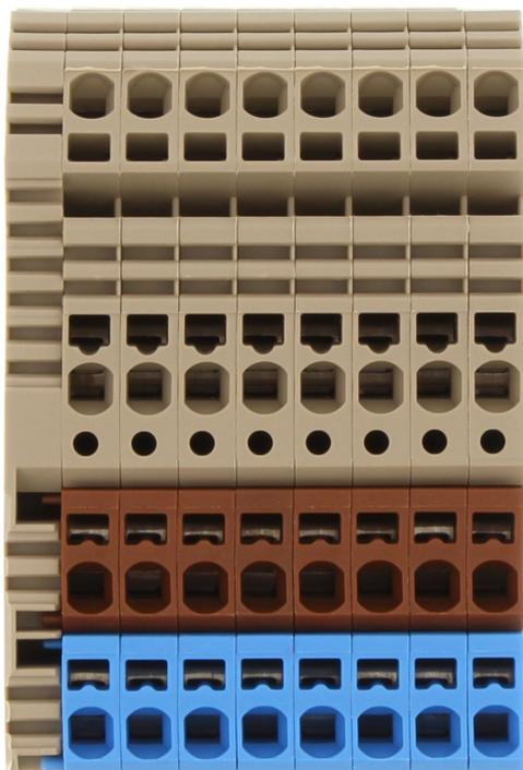
Initiatorenklemme/Aktorenklemme, Zugfederanschluss, Montageart: TS 35/7,5, Bemessungsquerschnitt: 1,5 mm<sup>2</sup>, Breite: 45,9 mm, Farbe: Mehrfarbig
