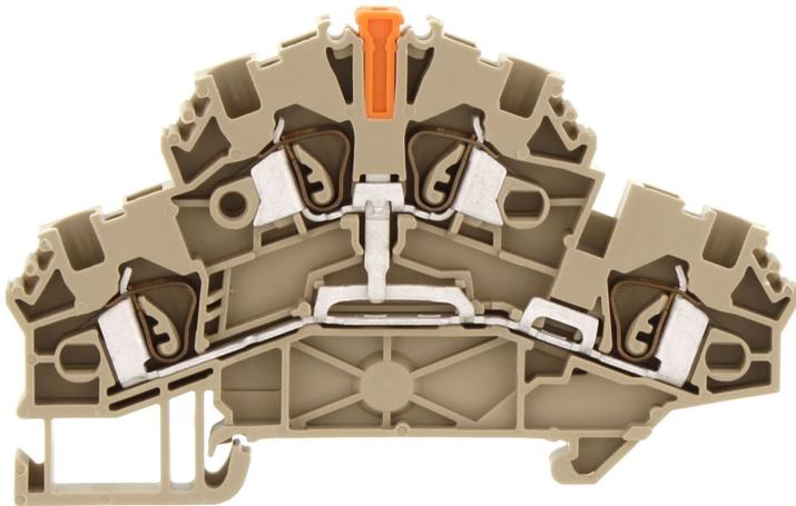
Doppelstockklemme, Zugfederanschluss, Montageart: TS 35/7,5, Bemessungsquerschnitt: 2,5 mm<sup>2</sup>, Breite: 5,1 mm, Farbe: Beige
