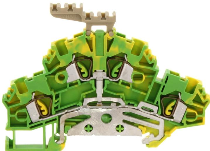
Schutzleiter-Doppelstockklemme, Zugfederanschluss, Montageart: TS 35/7,5, Bemessungsquerschnitt: 2,5 mm<sup>2</sup>, Breite: 5,1 mm, Farbe: Grün-gelb
