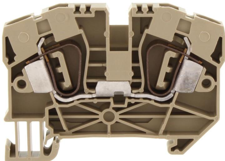
Durchgangsklemme, Zugfederanschluss, Montageart: TS 35/7,5, Bemessungsquerschnitt: 6 mm<sup>2</sup>, Breite: 8,1 mm, Farbe: Beige
