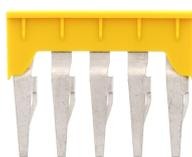
Querverbinder isoliert, Polzahl: 5, Montageart: Stecken, Breite: 31,9 mm, Bemessungsquerschnitt: 6 mm<sup>2</sup>, Farbe: Gelb
