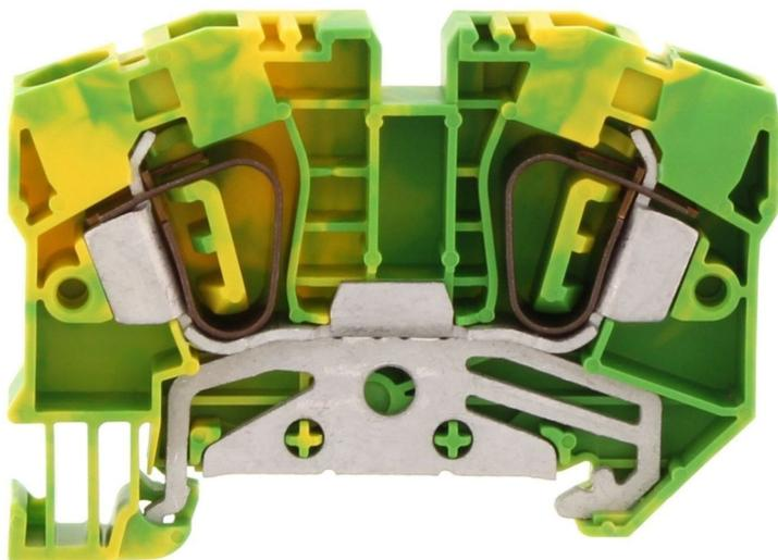
Schutzleiterklemme, Zugfederanschluss, Montageart: TS 35/7,5, Bemessungsquerschnitt: 6 mm<sup>2</sup>, Breite: 8,1 mm, Farbe: Grün-gelb
