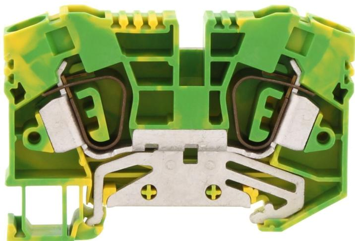
Schutzleiterklemme, Zugfederanschluss, Montageart: TS 35/7,5, Bemessungsquerschnitt: 10 mm<sup>2</sup>, Breite: 10,1 mm, Farbe: Grün-gelb
