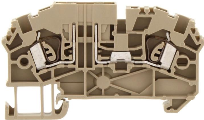
Grundklemme, Zugfederanschluss, Montageart: TS 35/7,5, Bemessungsquerschnitt: 2,5 mm<sup>2</sup>, Breite: 5,1 mm, Farbe: Beige
