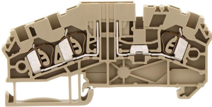
Grundklemme, Zugfederanschluss, Montageart: TS 35/7,5, Bemessungsquerschnitt: 2,5 mm<sup>2</sup>, Breite: 5,1 mm, Farbe: Beige
