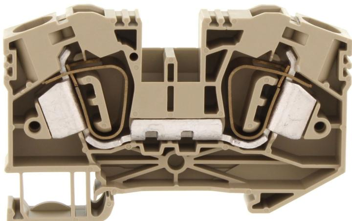
Durchgangsklemme, Zugfederanschluss, Montageart: TS 35/7,5, Bemessungsquerschnitt: 16 mm<sup>2</sup>, Breite: 12,1 mm, Farbe: Beige
