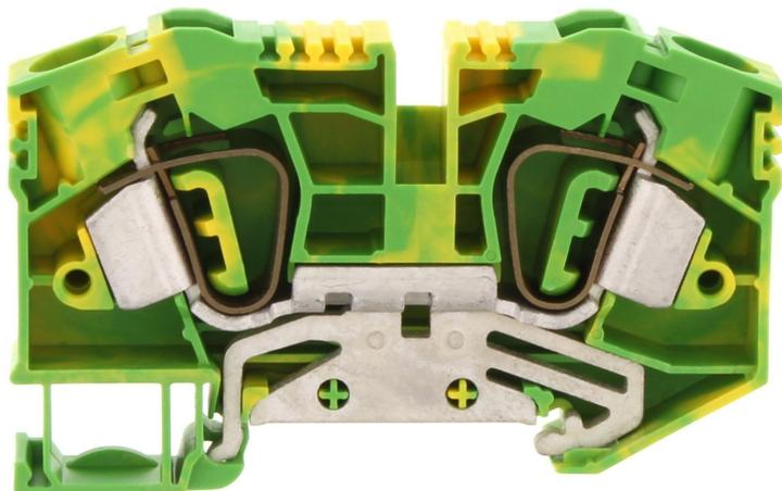
Schutzleiterklemme, Zugfederanschluss, Montageart: TS 35/7,5, Bemessungsquerschnitt: 16 mm<sup>2</sup>, Breite: 12,1 mm, Farbe: Grün-gelb
