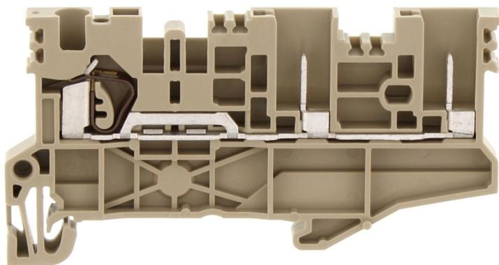
Durchgangsklemme, Zugfederanschluss, Montageart: TS 35/7,5, Bemessungsquerschnitt: 2,5 mm<sup>2</sup>, Breite: 5,1 mm, Farbe: Beige
