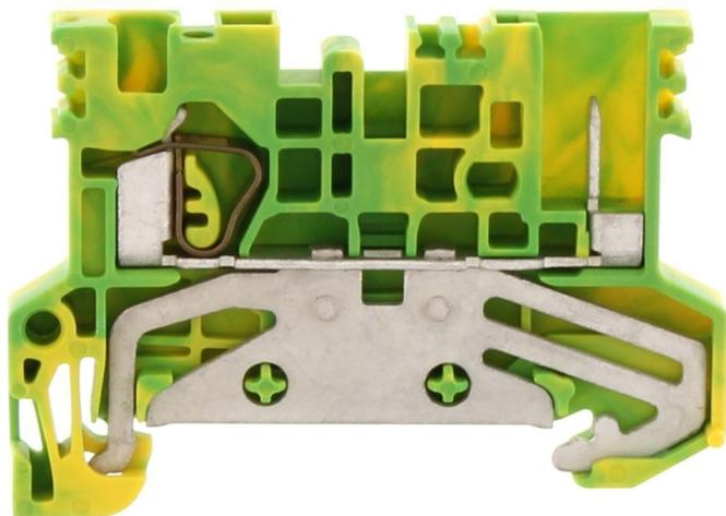
Schutzleiterklemme, Zugfederanschluss, Montageart: TS 35/7,5, Bemessungsquerschnitt: 2,5 mm<sup>2</sup>, Breite: 5,1 mm, Farbe: Grün-gelb
