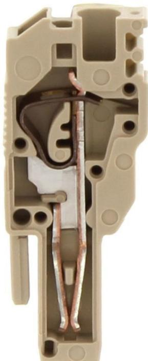
Durchgangsklemme, Zugfederanschluss, Montageart: Stecken, Bemessungsquerschnitt: 2,5 mm<sup>2</sup>, Breite: 5,1 mm, Farbe: Beige
