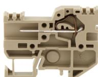
Durchgangsklemme, Zugfederanschluss, Montageart: TS 15/5,5, Bemessungsquerschnitt: 2,5 mm<sup>2</sup>, Breite: 5,1 mm, Farbe: Beige
