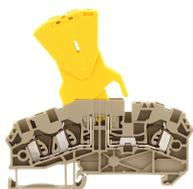
Sicherungstrennklemme, Zugfederanschluss, Montageart: TS 35/7,5, Bemessungsquerschnitt: 2,5 mm<sup>2</sup>, Breite: 5,1 mm, Farbe: Beige
