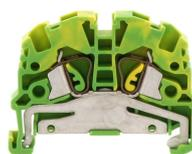
Schutzleiterklemme, Zugfederanschluss, Montageart: TS 35/7,5, Bemessungsquerschnitt: 2,5 mm<sup>2</sup>, Breite: 5,1 mm, Farbe: Grün-gelb
