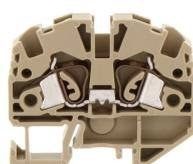
Ex-Durchgangsklemme zertifiziert nach ATEX, Zugfederanschluss, Montageart: TS 15/5,5, Bemessungsquerschnitt: 2,5 mm<sup>2</sup>, Breite: 5,1 mm, Farbe: Beige
