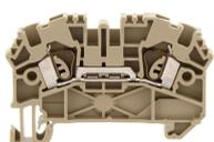
Ex-Durchgangsklemme zertifiziert nach ATEX, Zugfederanschluss, Montageart: TS 35/7,5, Bemessungsquerschnitt: 2,5 mm<sup>2</sup>, Breite: 5,1 mm, Farbe: Beige
