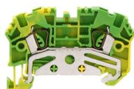
Ex-Schutzleiterklemme zertifiziert nach ATEX, Zugfederanschluss, Montageart: TS 35/7,5, Bemessungsquerschnitt: 2,5 mm<sup>2</sup>, Breite: 5,1 mm, Farbe: Grün-gelb
