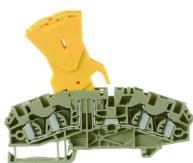
Sicherungstrennklemme, Zugfederanschluss, Montageart: TS 35/7,5, Bemessungsquerschnitt: 2,5 mm<sup>2</sup>, Breite: 5,1 mm, Farbe: Beige
