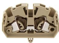
Durchgangsklemme zur Direktmontage, Zugfederanschluss, Montageart: Montagefläche, Bemessungsquerschnitt: 2,5 mm<sup>2</sup>, Breite: 5,1 mm, Farbe: Beige
