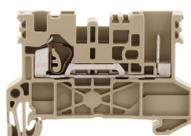
Durchgangsklemme, Zugfederanschluss, Montageart: TS 35/7,5, Bemessungsquerschnitt: 2,5 mm<sup>2</sup>, Breite: 5,1 mm, Farbe: Beige
