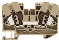
Ex-Durchgangsklemme zertifiziert nach ATEX, Zugfederanschluss, Montageart: TS 35/7,5, Bemessungsquerschnitt: 10 mm<sup>2</sup>, Breite: 10,1 mm, Farbe: Beige
