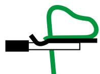
Durchgangsklemme, Zugfederanschluss, Montageart: Stecken, Bemessungsquerschnitt: 2,5 mm<sup>2</sup>, Breite: 15,3 mm, Farbe: Beige
