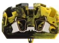
Durchgangsklemme zur Direktmontage, Zugfederanschluss, Montageart: Montagefläche, Bemessungsquerschnitt: 2,5 mm<sup>2</sup>, Breite: 5,1 mm, Farbe: Schwarz-gelb
