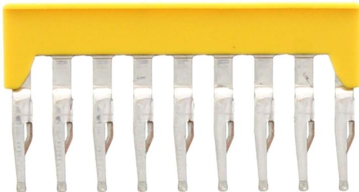
Querverbinder isoliert, Polzahl: 9, Montageart: Stecken, Breite: 44,8 mm, Bemessungsquerschnitt: 2,5 mm<sup>2</sup>, Farbe: Gelb
