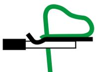
Durchgangsklemme, Zugfederanschluss, Montageart: Stecken, Bemessungsquerschnitt: 2,5 mm<sup>2</sup>, Breite: 56,1 mm, Farbe: Beige
