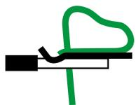
Durchgangsklemme, Zugfederanschluss, Montageart: Stecken, Bemessungsquerschnitt: 2,5 mm<sup>2</sup>, Breite: 15,3 mm, Farbe: Beige
