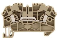
Durchgangsklemme, Zugfederanschluss, Montageart: TS 35/7,5, Bemessungsquerschnitt: 2,5 mm<sup>2</sup>, Breite: 5,1 mm, Farbe: Beige
