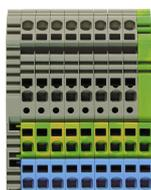
Initiatorenklemme/Aktorenklemme, Zugfederanschluss, Montageart: TS 35/7,5, Bemessungsquerschnitt: 1,5 mm<sup>2</sup>, Breite: 61,2 mm, Farbe: Mehrfarbig
