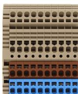
Initiatorenklemme/Aktorenklemme, Zugfederanschluss, Montageart: TS 35/7,5, Bemessungsquerschnitt: 1,5 mm<sup>2</sup>, Breite: 56,1 mm, Farbe: Mehrfarbig
