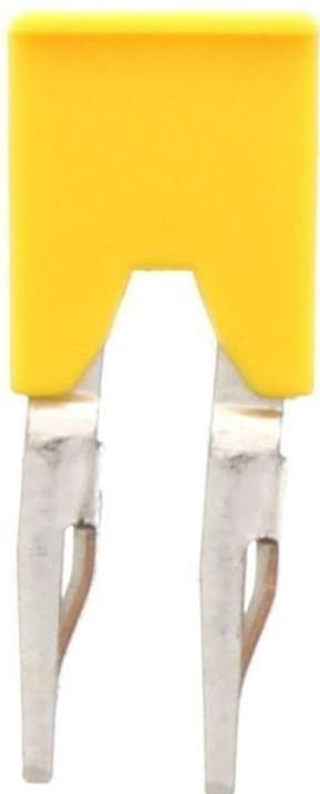
Querverbinder isoliert, Polzahl: 2, Montageart: Stecken, Breite: 10,1 mm, Bemessungsquerschnitt: 4 mm<sup>2</sup>, Farbe: Gelb
