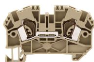
Ex-Durchgangsklemme zertifiziert nach ATEX, Zugfederanschluss, Montageart: TS 35/7,5, Bemessungsquerschnitt: 4 mm<sup>2</sup>, Breite: 6,1 mm, Farbe: Beige
