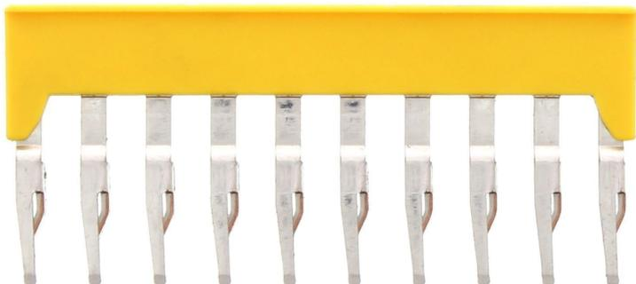
Querverbinder isoliert, Polzahl: 10, Montageart: Stecken, Breite: 58,9 mm, Bemessungsquerschnitt: 4 mm<sup>2</sup>, Farbe: Gelb
