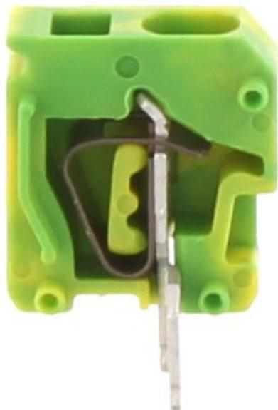
Potentialverteilerleiste, Zugfederanschluss, Montageart: Stecken, Bemessungsquerschnitt: 1,5 mm<sup>2</sup>, Breite: 8,7 mm, Farbe: Grün-gelb
