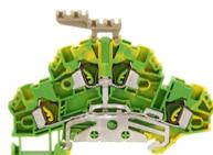
Schutzleiter-Doppelstockklemme, Zugfederanschluss, Montageart: TS 35/7,5, Bemessungsquerschnitt: 2,5 mm<sup>2</sup>, Breite: 5,1 mm, Farbe: Grün-gelb
