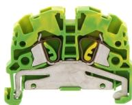
Ex-Schutzleiterklemme zertifiziert nach ATEX, Zugfederanschluss, Montageart: TS 35/7,5, Bemessungsquerschnitt: 2,5 mm<sup>2</sup>, Breite: 5,1 mm, Farbe: Grün-gelb
