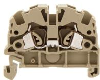
Durchgangsklemme, Zugfederanschluss, Montageart: TS 35/7,5, Bemessungsquerschnitt: 2,5 mm<sup>2</sup>, Breite: 5,1 mm, Farbe: Beige
