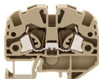
Durchgangsklemme, Zugfederanschluss, Montageart: TS 15/5,5, Bemessungsquerschnitt: 2,5 mm<sup>2</sup>, Breite: 5,1 mm, Farbe: Beige
