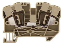
Ex-Durchgangsklemme zertifiziert nach ATEX, Zugfederanschluss, Montageart: TS 35/7,5, Bemessungsquerschnitt: 6 mm<sup>2</sup>, Breite: 8,1 mm, Farbe: Beige
