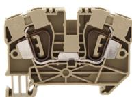
Durchgangsklemme, Zugfederanschluss, Montageart: TS 35/7,5, Bemessungsquerschnitt: 6 mm<sup>2</sup>, Breite: 8,1 mm, Farbe: Beige
