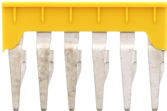
Querverbinder isoliert, Polzahl: 6, Montageart: Stecken, Breite: 48,1 mm, Bemessungsquerschnitt: 6 mm<sup>2</sup>, Farbe: Gelb
