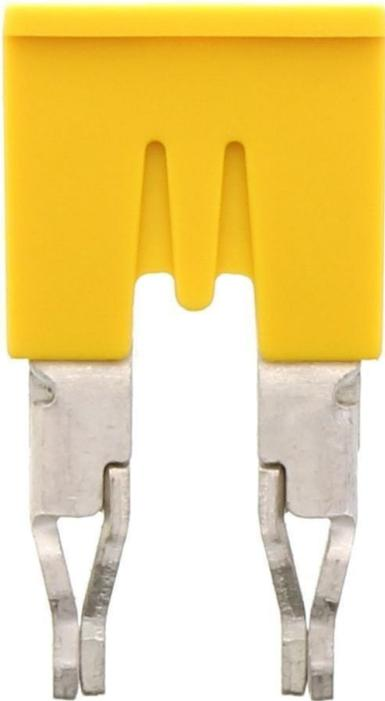
Querverbinder isoliert, Polzahl: 2, Montageart: Stecken, Breite: 20,4 mm, Bemessungsquerschnitt: 16 mm<sup>2</sup>, Farbe: Gelb
