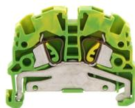
Schutzleiterklemme, Zugfederanschluss, Montageart: TS 35/7,5, Bemessungsquerschnitt: 2,5 mm<sup>2</sup>, Breite: 5,1 mm, Farbe: Grün-gelb
