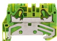
Schutzleiter-Installationsklemme, Push-in-Anschluss, Montageart: TS 35/7,5, Bemessungsquerschnitt: 4 mm<sup>2</sup>, Breite: 5,1 mm, Farbe: Grün-gelb
