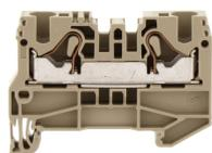
Durchgangs-Installationsklemme, Push-in-Anschluss, Montageart: TS 35/7,5, Bemessungsquerschnitt: 10 mm<sup>2</sup>, Breite: 8,1 mm, Farbe: Beige
