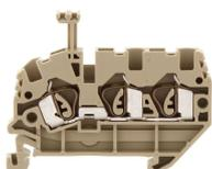
Ex-Durchgangsklemme zertifiziert nach ATEX, Zugfederanschluss, Montageart: TS 35/7,5, Bemessungsquerschnitt: 2,5 mm<sup>2</sup>, Breite: 5,1 mm, Farbe: Beige
