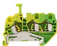
Ex-Schutzleiterklemme zertifiziert nach ATEX, Zugfederanschluss, Montageart: TS 35/7,5, Bemessungsquerschnitt: 2,5 mm<sup>2</sup>, Breite: 5,1 mm, Farbe: Grün-gelb
