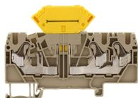
Trennklemme, Push-in-Anschluss, Montageart: TS 35/7,5, Bemessungsquerschnitt: 2,5 mm<sup>2</sup>, Breite: 5,1 mm, Farbe: Beige
