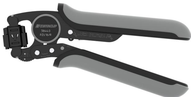
Crimpwerkzeug zum Crimpen von Aderendhülsen mit und ohne Kunststoffkragen. Querschnittsbereich: 0,08-16 mm<sup>2</sup> (AWG 28-5). Leichte Handhabung, Zwangssperre für korrektes vollständiges Crimpen, Leitereinführung in 45° Schritten drehbar, selbstöffnend durch eingebaute Feder.
