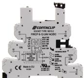
Interface-Relais-Compact (IRC) Stecksocket FIRC mit Push-in-Anschluss, Montageart: TS 35, 1 Wechsler, Eingangsspannung: 6,12 oder 24 VAC/DC
