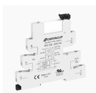
Interface-Relais-Compact (IRC) Komplett, bestehend aus Sockel IRCI... mit Schraubanschluss und steckbarem Miniaturrelais PRC... mit Leistungskontakt, Montageart: TS 35, 1 Wechsler, Eingangsspannung: 240 VAC
