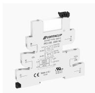
Interface-Relais-Compact (IRC) Komplett, bestehend aus Sockel IRCI... mit Schraubanschluss und steckbarem Miniaturrelais PRC... mit Leistungskontakt, Montageart: TS 35, 1 Wechsler, Eingangsspannung: 125 VAC/DC
