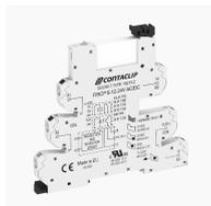
Interface-Relais-Compact (IRC) Komplett, bestehend aus Sockel FIRCP... mit Push-in-Anschluss und steckbarem Miniaturrelais mit Leistungskontakt, Montageart: TS 35, 1 Wechsler, Eingangsspannung: 125 VDC
