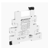
Interface-Relais-Compact (IRC) Komplett, bestehend aus Sockel IRC... mit Schraubanschluss und steckbarem Miniaturrelais PRC... mit Leistungskontakt, Montageart: TS 35, 1 Wechsler, Eingangsspannung: 125 VAC/DC
