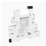
Interface-Relais-Compact (IRC) Komplett, bestehend aus Sockel IRC... mit Schraubanschluss und steckbarem Miniaturrelais PRC... mit Leistungskontakt, Montageart: TS 35, 1 Wechsler, Eingangsspannung: 240 VAC
