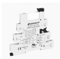
Interface-Relais-Compact (IRC) Komplett, bestehend aus Sockel IRCP... mit Schraubanschluss und steckbarem Miniaturrelais PRC... mit Leistungskontakt, Montageart: TS 35, 1 Wechsler, Eingangsspannung: 60 VAC/DC
