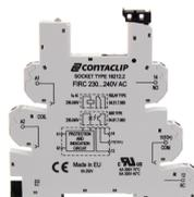
Interface-Relais-Compact (IRC) Stecksocket FIRC mit Push-in-Anschluss, Montageart: TS 35, 1 Wechsler, Eingangsspannung: 230 bis 240 VAC
