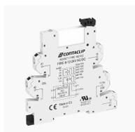
Interface-Relais-Compact (IRC) Komplett, bestehend aus Sockel FIRCU... mit Push-in-Anschluss und steckbarem Miniaturrelais mit Leistungskontakt, Montageart: TS 35, 1 Wechsler, Eingangsspannung: 12 VAC/DC
