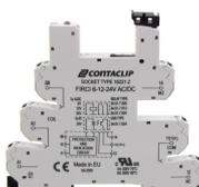
Interface-Relais-Compact (IRC) Stecksocket FIRCI I mit Push-in-Anschluss, Montageart: TS 35, 1 Wechsler, Eingangsspannung: 6 bis 24 VAC/DC
