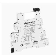
Interface-Relais-Compact (IRC) Komplett, bestehend aus Sockel FIRCU... mit Push-in-Anschluss und steckbarem Miniaturrelais mit Leistungskontakt, Montageart: TS 35, 1 Wechsler, Eingangsspannung: 240 VAC
