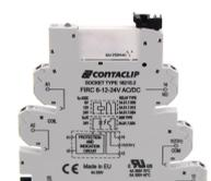
Interface-Relais-Compact (IRC) Komplett, bestehend aus Sockel FIRCU... mit Push-in-Anschluss und steckbarem Miniaturrelais mit Leistungskontakt, Montageart: TS 35, 1 Wechsler, Eingangsspannung: 24 VAC/DC
