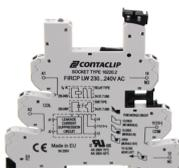
Interface-Relais-Compact (IRC) Stecksocket FIRCP P mit Push-in-Anschluss und Reststromunterdrückung für lange Leitungswege, Montageart: TS 35, 1 Wechsler, Eingangsspannung: 230 bis 240 VAC/DC
