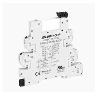
Interface-Relais-Compact (IRC) Komplett, bestehend aus Sockel FIRCO... mit Push-in-Anschluss und steckbarem Miniaturrelais mit Leistungskontakt, Montageart: TS 35, 1 Wechsler, Eingangsspannung: 125 VAC/DC
