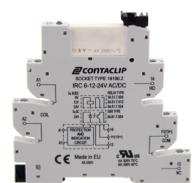
Interface-Relais-Compact (IRC) Komplett, bestehend aus Sockel IRC... mit Schraubanschluss und steckbarem Miniaturrelais PRC... mit Leistungskontakt, Montageart: TS 35, 1 Wechsler, Eingangsspannung: 6 VAC/DC
