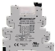
Interface-Relais-Compact (IRC) Komplett, bestehend aus Sockel IRC... mit Schraubanschluss und steckbarem Miniaturrelais PRC... mit Leistungskontakt, Montageart: TS 35, 1 Wechsler, Eingangsspannung: 24 VAC/DC
