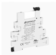
Interface-Relais-Compact (IRC) Komplett, bestehend aus Sockel IRC... mit Schraubanschluss und steckbarem Miniaturrelais PRC... mit Leistungskontakt, Montageart: TS 35, 1 Wechsler, Eingangsspannung: 12 VAC/DC
