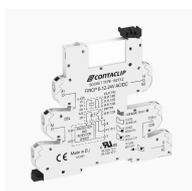
Interface-Relais-Compact (IRC) Stecksocket FIRCP P mit Push-in-Anschluss und Reststromunterdrückung für lange Leitungswege, Montageart: TS 35, 1 Wechsler, Eingangsspannung: 110 bis 125 VAC/DC
