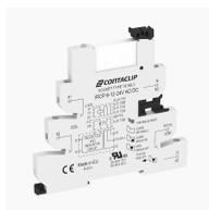
Interface-Relais-Compact (IRC) Komplett, bestehend aus Sockel IRCP... mit Schraubanschluss und steckbarem Miniaturrelais PRC... mit Leistungskontakt, Montageart: TS 35, 1 Wechsler, Eingangsspannung: 12 VAC/DC
