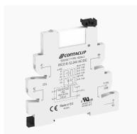
Interface-Relais-Compact (IRC) Komplett, bestehend aus Sockel IRCO... mit Schraubanschluss und steckbarem Miniaturrelais PRC... mit Leistungskontakt, Montageart: TS 35, 1 Wechsler, Eingangsspannung: 6 VAC/DC
