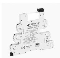
Interface-Relais-Compact (IRC) Komplett, bestehend aus Sockel FIRCI... mit Push-in-Anschluss und steckbarem Miniaturrelais mit Leistungskontakt, Montageart: TS 35, 1 Wechsler, Eingangsspannung: 12 VAC/DC
