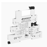
Interface-Relais-Compact (IRC) Stecksocket IRCP mit Schraubanschluss und Reststromunterdrückung für lange Leitungswege, Montageart: TS 35, 1 Wechsler, Eingangsspannung: 110 bis 125 VAC/DC
