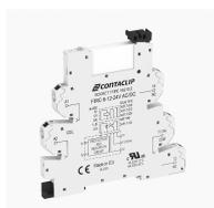
Interface-Relais-Compact (IRC) Komplett, bestehend aus Sockel FIRCU... mit Push-in-Anschluss und steckbarem Miniaturrelais mit Leistungskontakt, Montageart: TS 35, 1 Wechsler, Eingangsspannung: 6 VAC/DC
